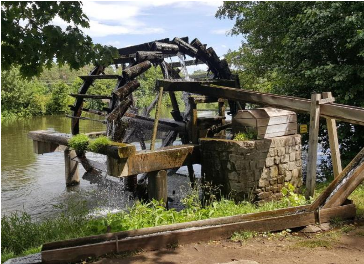
Abb. 3: Wasserschöpfräder wie dieses bei Hausen an der Regnitz wurden früher genutzt, um Wasser aus eingetieften Fließgewässern in höher gelegene landwirtschaftliche Flächen einzuleiten. Foto: Gemeinde Hausen
